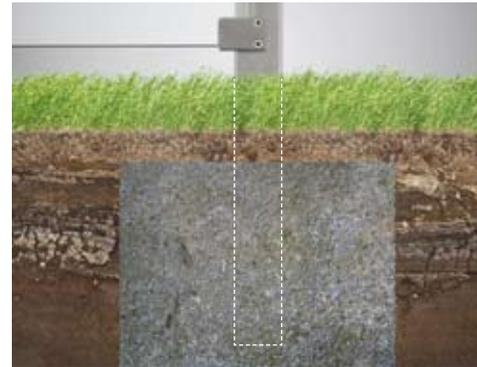
Pfosten-Set\* mit Verlängerung zum Einbetonieren.
