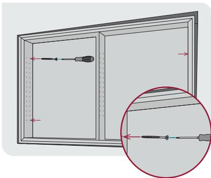
**10** • Setzen Sie nun den Schrank in den Einbaurahmen ein und verschrauben Sie diese fest zusammen. Für das Verschrauben können auch die vorgegebenen oberen und unteren Löcher verwendet werden.
