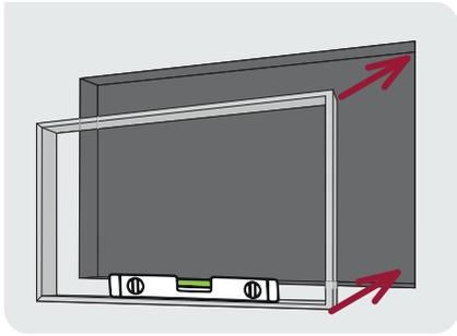
**8** • Setzen Sie den Einbaurahmen in die Wandnische ein und richten Sie diesen mit der Wasserwaage aus.
