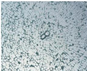
gegen Temperaturwechsel und hohe Temperaturunterschiede innerhalb einer Scheibe deutlich erhöht. Wenn ESG bei Überbeanspruchung zerbricht, zerfällt es in ein Netz stumpfkantiger, lose zusammenhängender Krümel, die eine weitaus geringere Verletzungsgefahr darstellen als die scharfkantigen Scherben von normal gekühltem oder teilvorgespanntem Glas.
