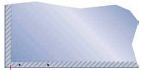
3 Isolierglas: Beschichtung wirkt als unsichtbare Alarmschleife und wird von einer Ausleseseinheit überwacht
