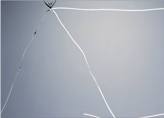
Abb. 2.6: Bruchbild Teilvorgespanntes Glas (TVG)
