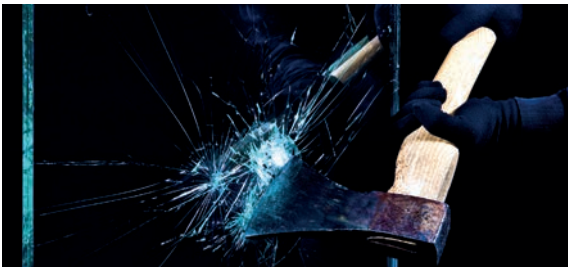
Abb. 7.5: Durchbruchversuch mit Axt
