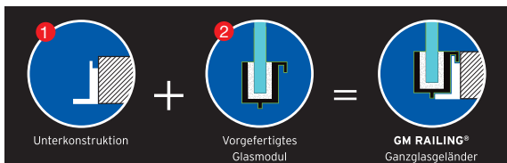
Abb. 8.57: Montage in 2 Schritten
