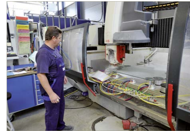
Links: Das brandneue, fünfschichtige CNC-Bearbeitungszentrum. Ein vertikales Schleif-, Bohr- und Fräszentrum ergänzt das High-Tech Bearbeitungsequipment. Rechts: Mit Einführung der ESG-Fertigung in 2008 wurde Frerichs Glas vollends zum Vollsortimenter im High-Quality Segment.
